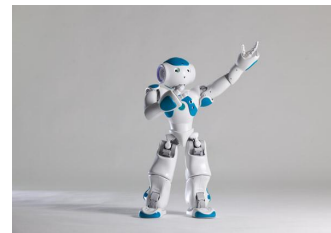
Le robot Nao peut communiquer, se déplacer et interagir avec son environnement s'il a été programmé.
