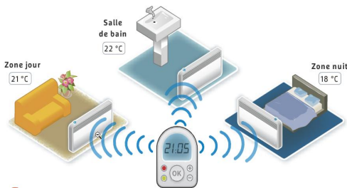
L'utilisateur peut programmer le chauffage dans chaque pièce en fonction de la température désirée et à des horaires définis.
