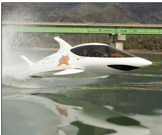
Le seabreacher est une embarcation nautique créée par Rob Innes et Dan Piazza. Dans le cockpit du seabreacher il y a 2 places. La puissance du moteur du seabreacher lui permet d'aller à 80 km/h à la surface de l'eau et en immersion il atteint les 40km/h. Le seabreacher peut plonger jusqu'à 2 mètres pendant 5 à 10 seconds et les pilotes les plus expérimentés peuvent rester pendant 1 min en immersion et il peut faire des sauts de 3 mètres et des 360 sur l'eau.
