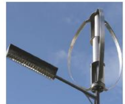
Le lampadaire éolien comporte son propre système d'alimentation
